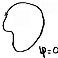
Или любого постоянного, что, впрочем, одно и то же. Внутри зарядов нет. Поле внутри любой точки этой поверхности равно нулю. Действительно, построим картину силовых линий. Они не могут начинаться и кончаться внутри этой поверхности — там нет зарядов. Они не могут идти от одной точки поверхности к
