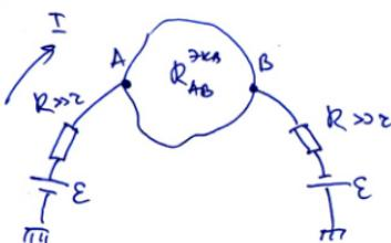
$$I = \frac{2\Sigma}{2R + R_{AB}^{\text{экв}}} \approx \frac{2\Sigma}{2R} = \frac{\Sigma}{R} \quad (\text{но всеми})$$
