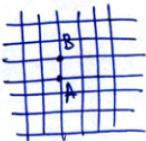
Замеч. 1.  $R_{AB}^{\text{экв}} < \Sigma$  (много параллельных к  $\Sigma$ )
